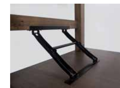
W金具（PAT.P）は横揺れを防ぎ一人で簡単に折畳み作業が可能
